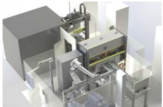
Abb. 8. MT-Prüfanlage mit automatisiertem Bauteiltransport
