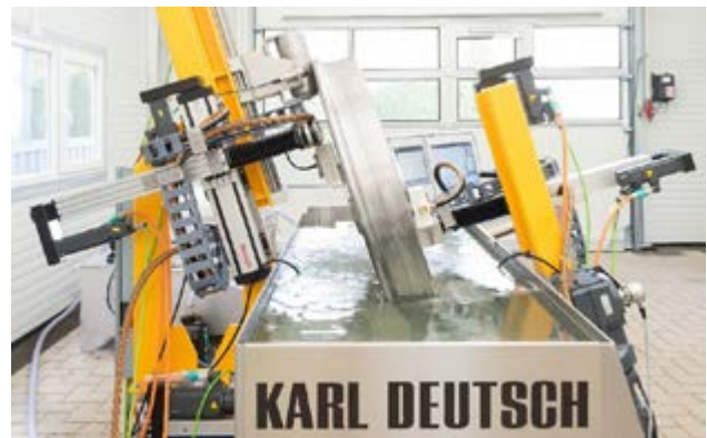
Abb. 4. Ultraschallprüfanlage für Bahnräder und Portalssystem zum Radtransport
