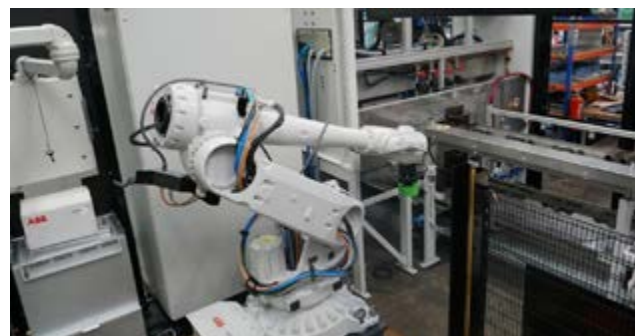
Abb. 9. Roboter mit Magnetgreifer zum Einfördern der Bauteile
