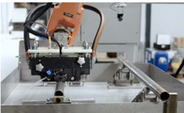
Abb. 3. Schweißnahtprüfanlage mit robotischer Bewegung des Prüfkopfhalters
