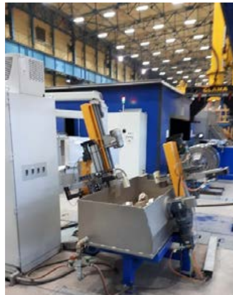
Abb. 4. Ultraschallprüfanlage für Bahnräder und Portalssystem zum Radtransport
