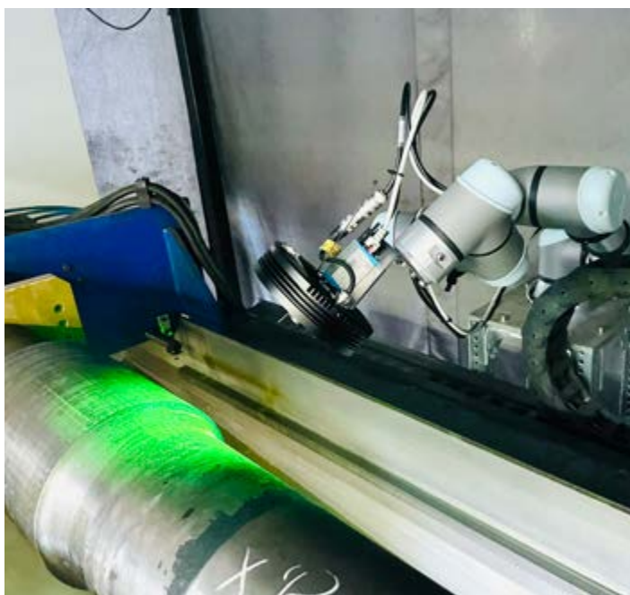
Abb. 11. CRACKVIEW AI-Rissbewertung an Radsatzwelle, die Kamera wird über einen Roboter positioniert.
