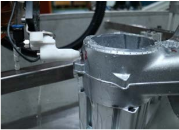
Abb. 6. Positionierung von Prüfkopf und Wasserdüse zur UT-Wanddickenmessung
