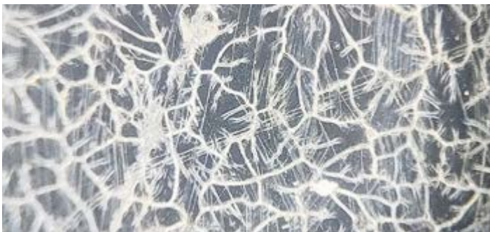
Aufnahme einer geätzten Stahloberfläche durch das MMM mit einer 400-fachen Vergrößerung
