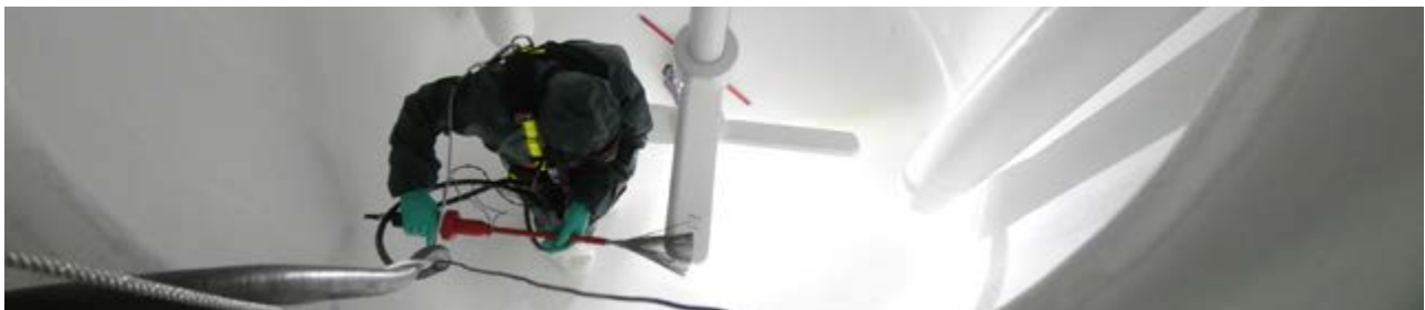
Emaillie-Behälter: Bei der klassischen Hochspannungsprüfung wird von außen an den metallischen Bereichen eine Erdung angebracht, die Emaillieoberfläche wird beispielsweise mit einem elektrisch leitenden Besen abgefahren. Hierbei werden kleinste Undichten durch einen Stromfluss angezeigt.
