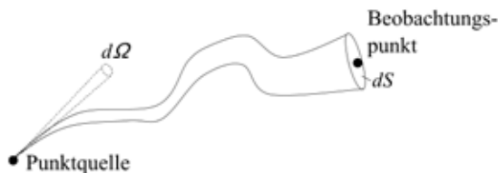
Abb. 2. Die semianalytische Simulation der Schallfeldentwicklung zum Beobachtungspunkt basiert in CIVA auf der Pencil-Methode nach [9].
