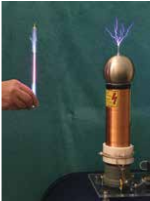
Bild 4: Vorführung der Fernübertragung von Energie mit 100 kV Tesla-Trafo.
