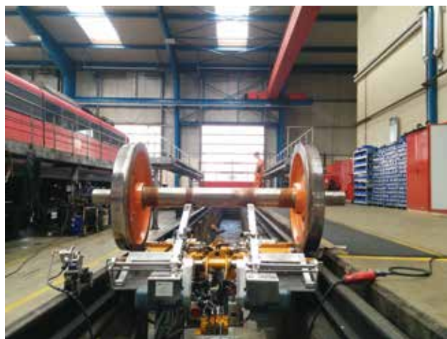
Abbildung 1: Mobile Vollwellenprüfanlage „VPS-Mobil 01“ bei der Prüfung einer Radsatzvollwelle an einem Güterwagen in der Servicestelle für Lokomotiven und Güterwagen, Rostock. Fotos: S. Bethke, DB Systemtechnik
