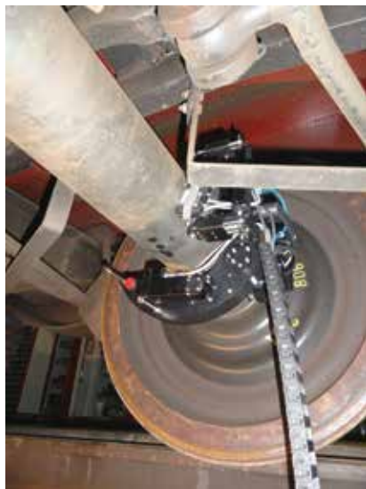
Abbildung 2: „VPS-Ring 01“ bei der Prüfung einer Radsatzvollwelle an einem Güterwagen in der Servicestelle für Lokomotiven und Güterwagen, Rostock. Fotos: S. Bethke, DB Systemtechnik GmbH
