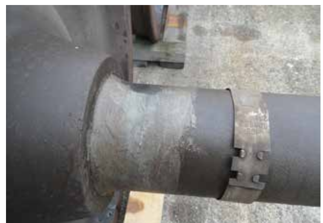
Abbildung 3: Oberflächenzustände innerhalb der Ankoppelbereiche Fotos: S. Bethke, DB Systemtechnik GmbH
