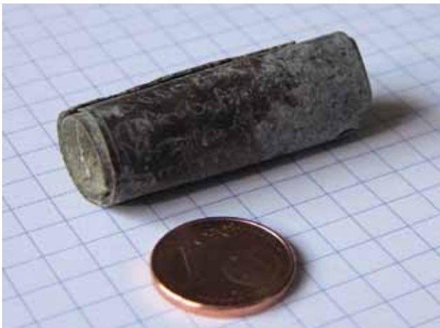
Abb. 1: Herausforderung für modernste Computertomographie: Was für ein vor eineinhalb Jahrtausenden in pures Blei geritzter mandäischer Text verbirgt sich im Innern? Die ursprünglich in einem Bronzeamulett aufbewahrte Rolle ist ca. 3,6 cm lang, 1,5 cm dick und im Innern stark korrodiert.
