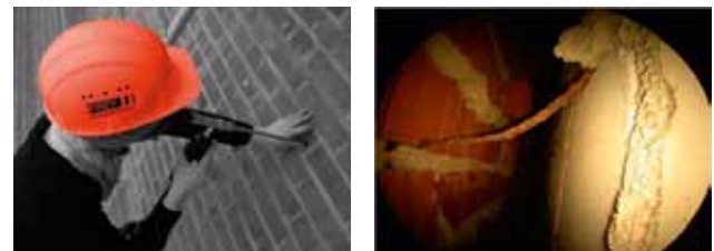
Abbildung 8: Hier ist die Endoskopie im Mauerwerk sichtbar. Auf Wunsch des Auftraggebers wurde hier in den Ziegel gebohrt. Üblich ist es, in den Fugenbereich zu bohren, um z. B. die Brandhaut des Ziegels nicht zu verletzen. Auf dem Foto rechts ist eine Endoskopieaufnahme in der Luftschicht des zweischaligen Mauerwerks sichtbar.
