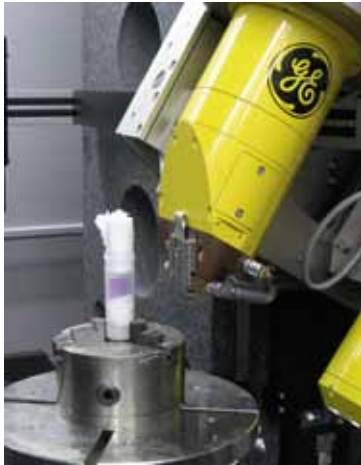
Abb. 3: Erfolgreicher 3D CT-Scan eines Bleiobjektes: Der phoenix v|tome|x von GE Inspection Technologies verfügt über eine 300 kV high-power mikrofokus Röntgenröhre. Mit ihr gelang es, die zum Schutz in Papier eingewickelte Bleirolle bei 290 kV Röntgenenergie zu durchstrahlen.
