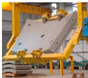
Abb. 1b: Tübbingproduktion im Fertigteilewerk; Eingesetzter Stahlfasertyp Dramix RC65/60BN [Bekaert]
