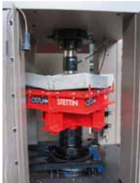
Abb. 3: Plattenbiegeversuch im SE-TMT nach ON EN 14488-5: Testkonfiguration und Rissbild
