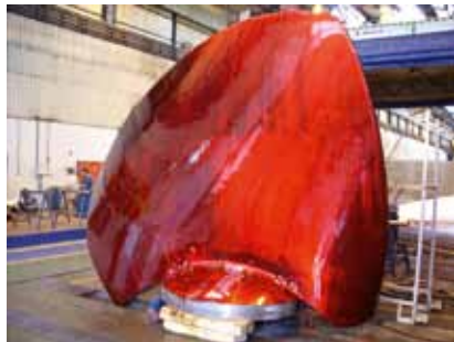
Kaplanschaufel bei der Eindringprüfung
