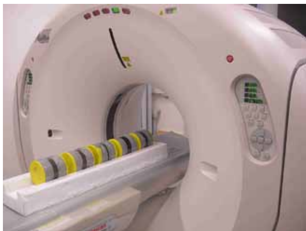
Abb. 6: 12 cm-Proben im medizinischen CT (Toshiba Aquilion CX)
