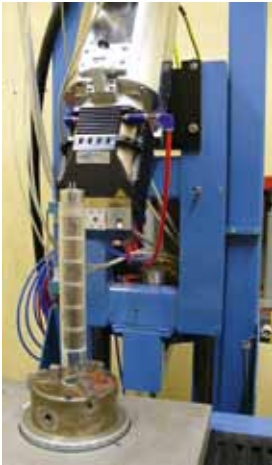
Links: Abb. 8a: Mikro-Computertomograph für Aufnahmen der kleinen Stechzylinder
