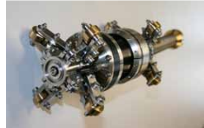
PushPull-System zur Inspektion z.B. von Pit-Leitungen auf Flughäfen
