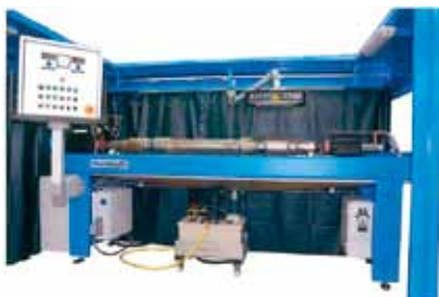
Rissprüfbank HELLMAG Typ Vario 2500
