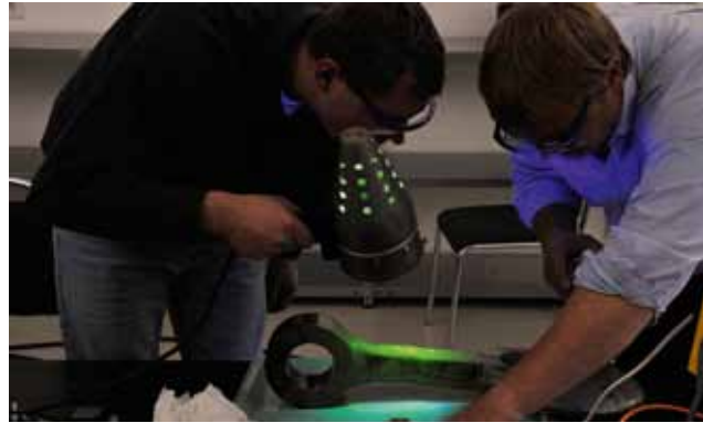
Magnetpulver-Prüfung im Ausbildungszentrum Magdeburg
