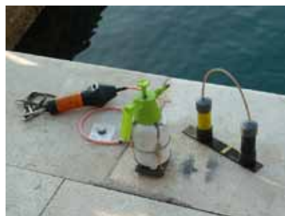
Handwerkzeug für die Unterwasser-Magnetpulverprüfung
