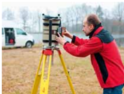
In-situ-Gammaspektrometer der Umgebungsüberwachung im Einsatz
