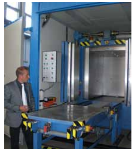
Blick in die geöffnete Messkammer der Freimessanlage
