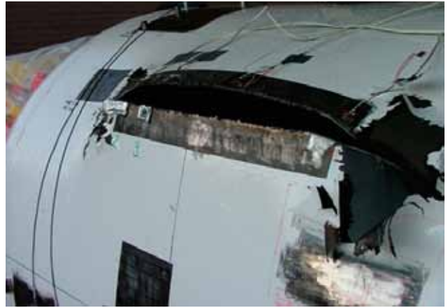
„Geplatzter“ Behälter nach dem Berst-Versuch
