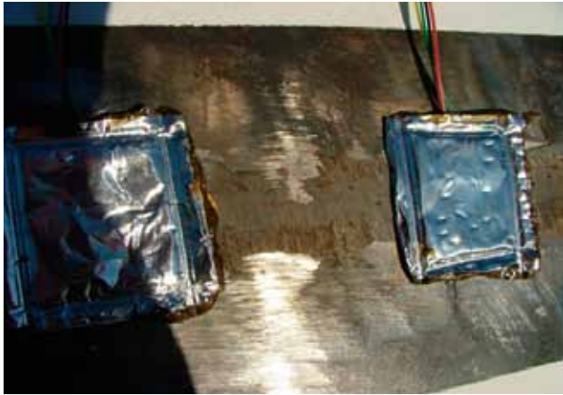
Eingebrachte Schweißnaht als Sollbruchstelle mit Dehnungsmessstreifen
