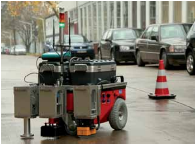
Abb. 3: Roboterplattform mit Sensorik (Wirbelstrom, Mikrowellen-Feuchtemesser, Ultraschallarray, Radar)
