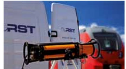
Mobile Durchstrahlungsprüfung mit Röntgenstrahlen bis 300kV
