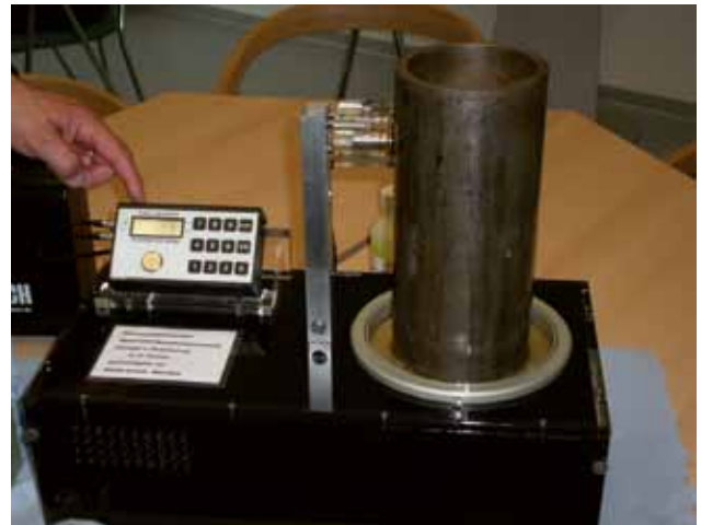
Modell des historischen Ultraschall-Wanddickenmessgeräts
