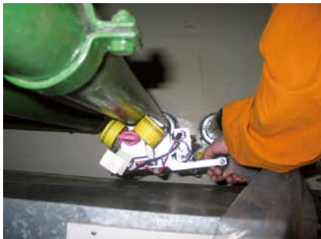
Abb. 5: SLOFEC™-System im Einsatz (Prüfbereich 06:00 Uhr-Pos.)
