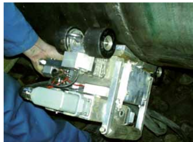
Abb. 4: Scanrichtung radial – Einsatz an Testrohrleitungen
