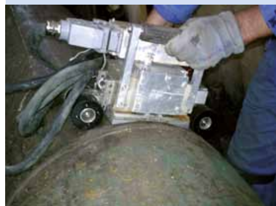
Fachbeitrag über Wirbelstromprüfung an Rohrleitungen im Kernkraftwerk Isar
