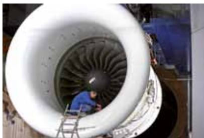
Das Triebwerk GP 7000 des A 380 auf dem Prüfstand der MTU Foto: MTU AE
