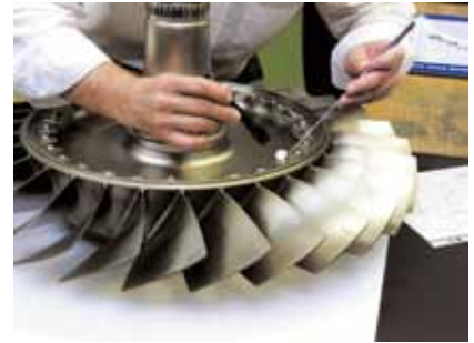
Sichtprüfung eines NDV-Blisk des Triebwerks EJ 200 Foto: MTU AE
