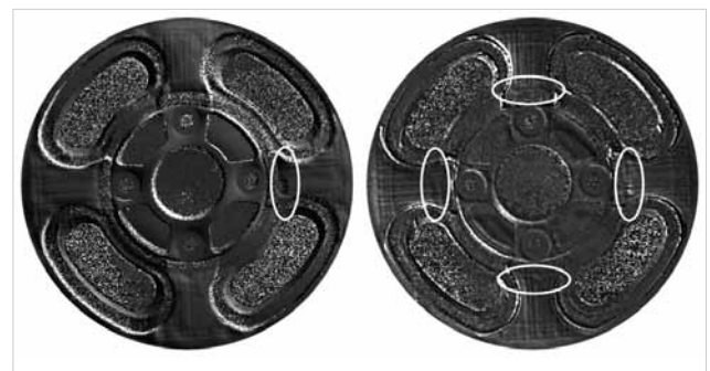
Abb. 7: CFK-Sandwich-Felgen mit Rissen in den Speichen (von weißen Ellipsen umrandet): links konventionelles Shearografie-Bild, rechts Lockin-Phasenbild
