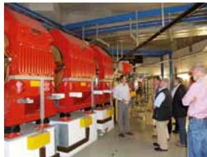
Magnetspulen zur Ausrichtung des Ionenstrahles
