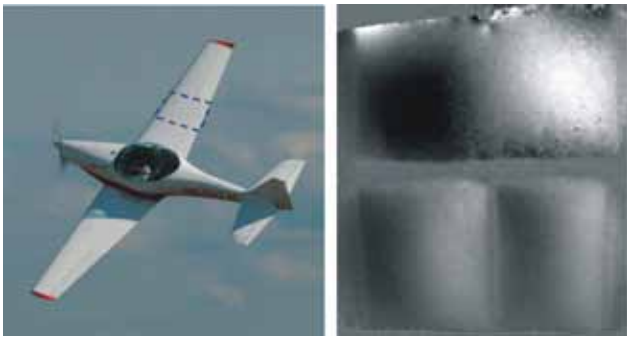
Abb.8: Ultraleichtflugzeug (links), Lockin-Amplitudenbild eines Tragflächenbereichs (rechts)
