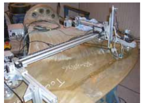
Bild 5: Einsatz des mobilen Prüfscanners bei WPNL; man erkennt unter anderem die Vakuumsaugfüsse zur Fixierung sowie den Mehrachsen-Scanner mit Antriebssteuerung.
