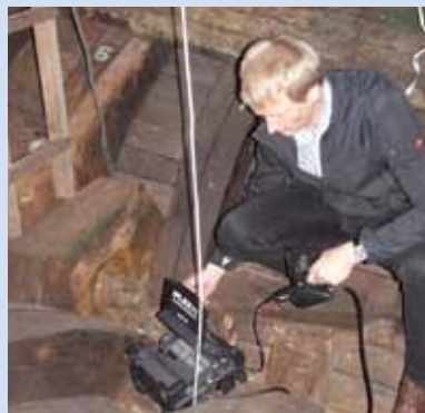
Ulf Reimer bei der endoskopischen Inspektion des Wellenganges
