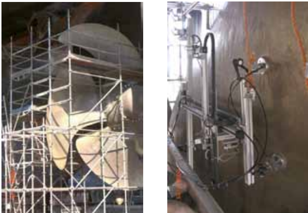
Bild 7: Prüfung eines montierten Propellers im Trockendock mit der senkrecht fixierten Scan-Einheit.
