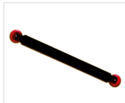
Bild 3: Kalibrier- und Prüfkörper zur Rückführung von CT-Messdaten
