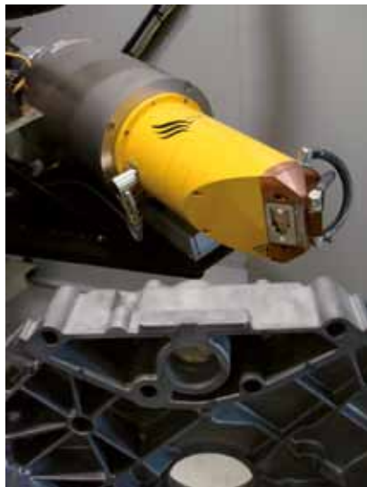
Bild 1: Die offene 225 kV Mikrofocus-Röntgenröhre der x|argos erlaubt hochauflösende Röntgeninspektion bei praktisch unbegrenzter Röhren-Lebensdauer.
