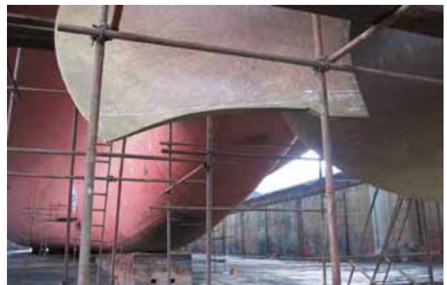
Bild 1: Kleine Ursache, große Wirkung – Schiff mit abgebrochenem Propellerflügel im Trockendock.
