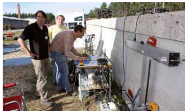
Zerstörungsfreie Beton-Untersuchung mit dem mobilen Ultraschall-Scanner „OSSCAR“
