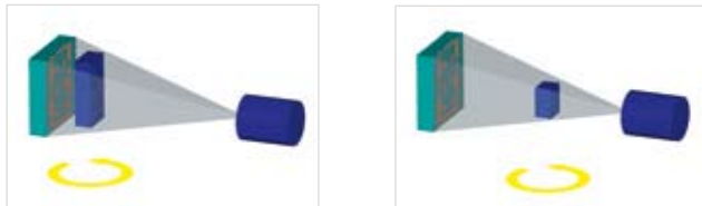
Bild 1: Prinzip der Computertomographie: Das Messobjekt befindet sich auf einem Drehtisch zwischen Röntgenquelle und Detektor. Ein geringer Abstand zwischen Objekt und Detektor ermöglicht die schnelle Erfassung größerer Bauteile mit niedriger Vergrößerung (Bild links); ein großer Abstand zwischen Detektor und Objekt führt zu einer hohen Vergrößerung für das Messen mit hoher Genauigkeit (Bild rechts)
