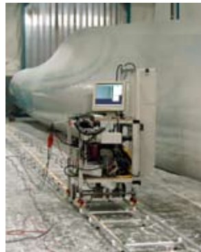
Abbildung 11: Bodengebundenes Thermographiesystem zur Rotorblattprüfung
