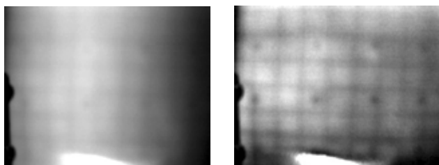
Abbildung 14: Unkorrigierte (links) und korrigierte (rechts) Thermographieaufnahme des Sandwichbereiches eines Rotorblattes
