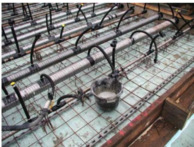
Bild 6: Großer Betonprobekörper der BAM während des Verpressens der Hüllrohre.
