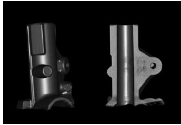
Lenkgehäuse mit Lunker
