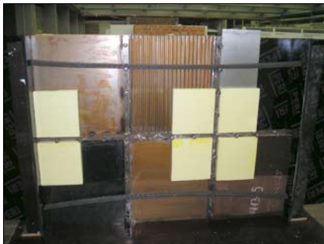
Bild 2: Fotografie des Plattentestkörpers vor der Betonierung (Sicht hinter die Stahlplatten).
