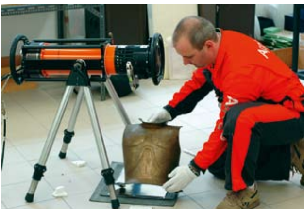
Abb. 3: Heiko Riemer von Applus RTD bei der Prüfung der Brustplatte eines metallisch erhaltenen griechischen Glockenpanzers (Olympia B 5101), 1. Hälfte 6. Jh. v. Chr.
