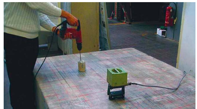
Abb. 15: IE-Messungen an einem mechanischen Schwingungen ausgesetzten Probekörper
