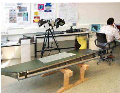
Abb. 2: Shearographie-Verfahren an einem Seitenruder
