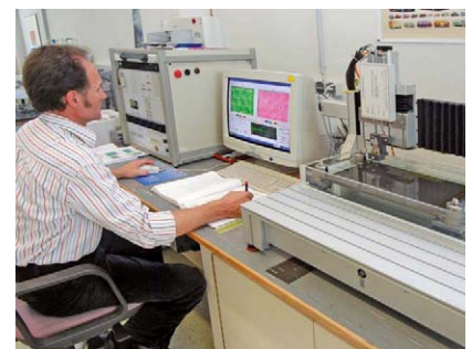
Abb. 4: Einzelelement-Ultraschall-Prüfkopf in Tauchtechnik
