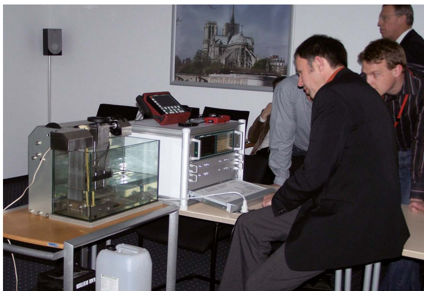
Ultraschallprüfung eines Rohrabchnitts im Wasserbad
