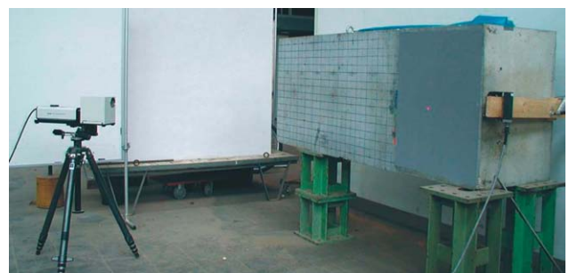
Abb. 3: Experimenteller Aufbau zur Visualisierung der Wellenausbreitung in Probekörperlängsrichtung. Die Anregung erfolgt über den am Probekörper befestigten Messkopf, die Messung durch ein scannendes Laservibrometer. Zur Erhöhung der Reflektivität ist der Probekörper mit einer retroreflektierenden Folie beschichtet.
