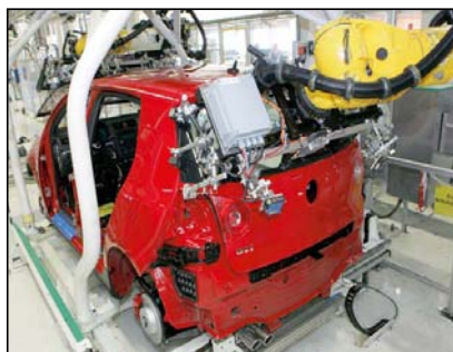
Einsetzen der Heckscheibe
