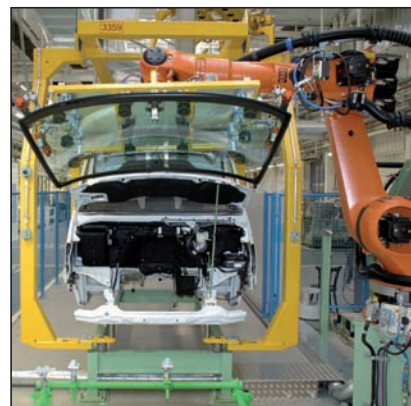
Die Frontscheibe wird automatisch und lasergestützt eingepasst
