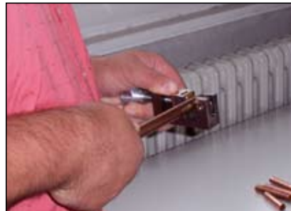
Ein Rohrschneider wird getestet
