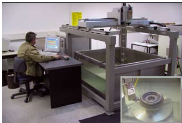
Bei der Ultraschallprüfung im Tauchtechnikverfahren wird der Prüfkopf mit einem 6-Achsen-Manipulator im Tauchbecken bewegt
