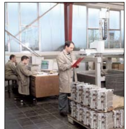
Prüfung von Gussteilen aus dem Verkehrswesen mit Hilfe der Ultraschall-Tauchtechnikanlage im Betrieb der MPV GmbH
