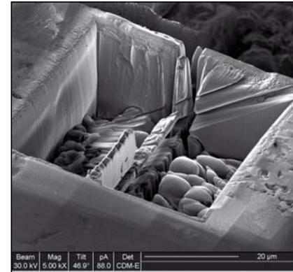
Mit Hilfe eines fokussierten Ionenstrahls (FIB) aus einem Schichtsystem herausgearbeitete Lamelle zur Untersuchung im Transmissionselektronenmikroskop.
