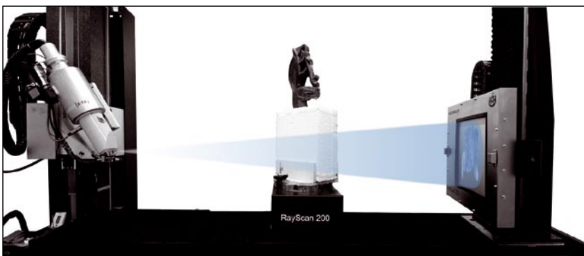
Treffen zwischen Archäologie und industrieller Hochtechnologie - Aufnahme des keltischen Objektes mit einem 3D-Computertomografen der Firma Wällischmiller an der TH Aalen. Das Projekt wurde betreut von Dr. Irmgard Pfeifer-Schaller
