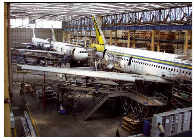
Im Inneren der Halle, in der Passagiermaschinen zu Frachtmaschi- nen umgerüstet werden
