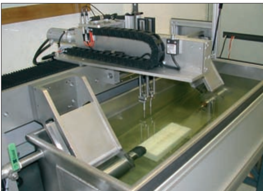
Blick auf das Tauchbecken: Man erkennt oben die Verfahrenseinheit für die Ultraschall-Prüfköpfe und unten die Probenaufnahme für Rundproben
