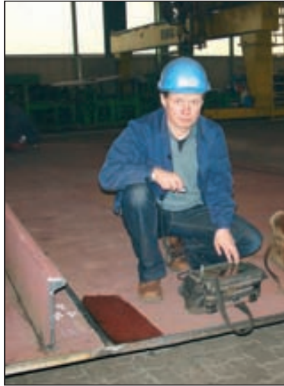
Frank Schmidt bei der Ultraschallprüfung einer Schweißnaht an einer Hauptmaschinenfundamentplatte
