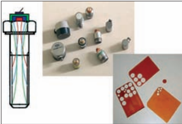
Abb. 3: Skizze einer gut und zweier weniger gut geeigneten Schallfeldausbildungen in einer Schraube und Abbildungen von handelsüblichen Ultraschallprüfköpfen zum Einbau in die Schraubennuss. Beispiele von Koppelfolien zur trockenen Schalleinprägung in die Schraube
