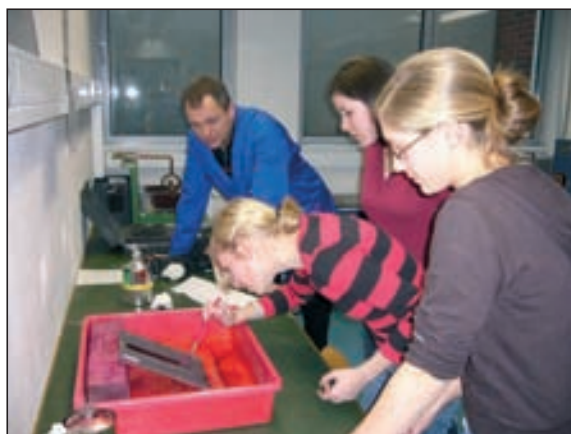
Vorsichtig wird das Eindringmittel aufgetragen
