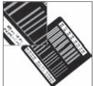
Abb. 7 Bildgüteprüfkörper (BPK) bei Zoom 1: Linienpaardigramm: 3,1 Lp/mm
