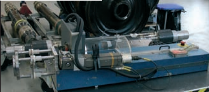
Die mechanisierte Ultraschall-Radsatzwellenprüfanlage für Radsatzwellen mit Längsbohrung
