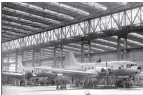
Montage des Passagierflugzeugs Iljuschin 14P
