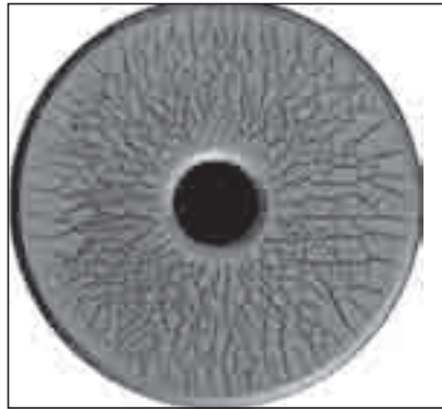
Anzeige mit Helling UG104A Untergrundfarbe, weiß und NRS Magnetpulversuspension, schwarz
