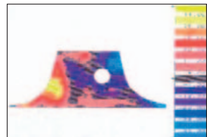
Mit dem PTR - Verfahren gemessene Verteilung der Gesamtspannung an einem komplizierten Maschinenteil. Die höchste Spannung ( \sigma_x und \sigma_y ) liegt exakt am Ort der grössten thermischen Belastung. Sie zeigt sich im Beispiel auf der linken Seite im gelben Feld.
