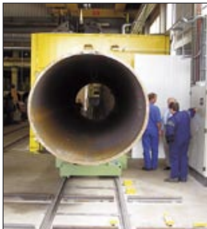
Der Strahlenschutz-tunnel von außen, das Stahlrohr vor der Einfahrt
