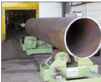
Das Stahlrohr auf dem Rohrtransportwagen (Handling)
