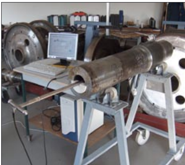
Prüfung einer Radsatzwelle mit Längsbohrung
