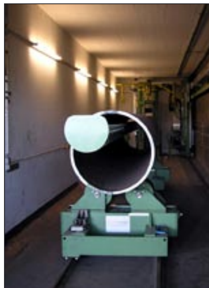
Das Stahlrohr in Prüfposition; Bei geschlossenem Strahlenschutz-tunnel werden die Röntgenröhren an einem Stativ oben über das Rohr bewegt (Strahlrichtung nach unten), auf dem Holm innerhalb des Rohres läuft das Detektorsystem synchron dazu
