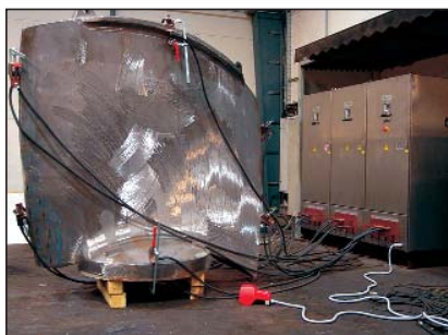
Multidirektionale Prüfanlage bei der Prüfung einer Kaplan-Turbinenschaufel
