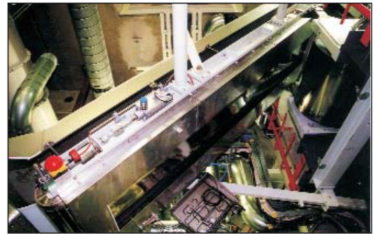
Rostfreies Stahlband 1700 SA im Einsatz in kleinem Förderer
