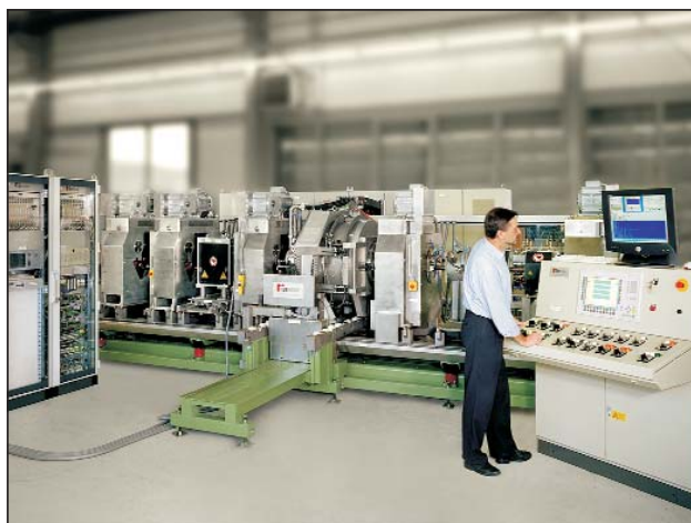
Eine Rotationsprüfanlage Rota 180 S zur Prüfung von Ölfeld-Rohren, aufgenommen in der Fertigungshalle in Alzenau. Die Anlage steht inzwischen bei TPCO in Tianjin in China
