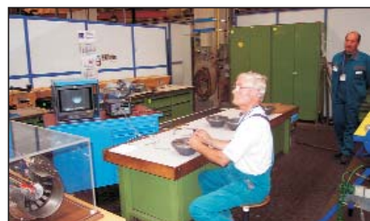
ZfP-Vorführung: Prüfung des Inneren eines Brenners mit Videoskopie
