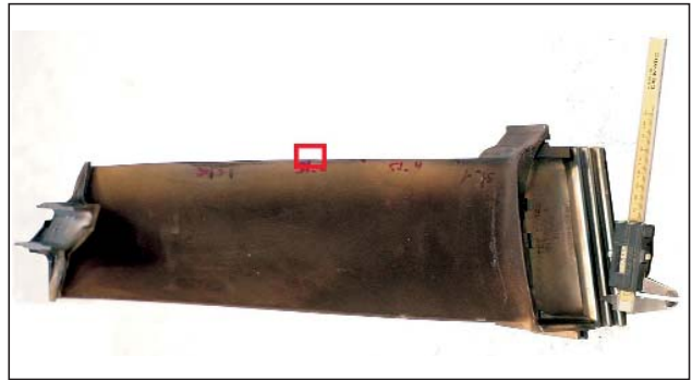
Abb.9: Gasturbinenschaufel, Markierung entspricht Prüfbereich
