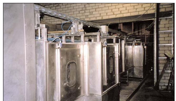
Vollautomatische Penetrieranlage für Vorderachsträger Fa. Honsel Meschede
