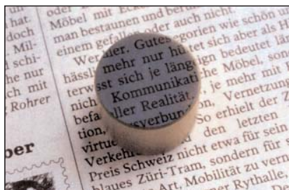
Die Wirkung eines Faserbündels: Die Bild-daten, die am Eingang auf die Glasfasern treffen, werden am Ende des Bündels direkt auf der Ausgangsebene wiedergegeben
