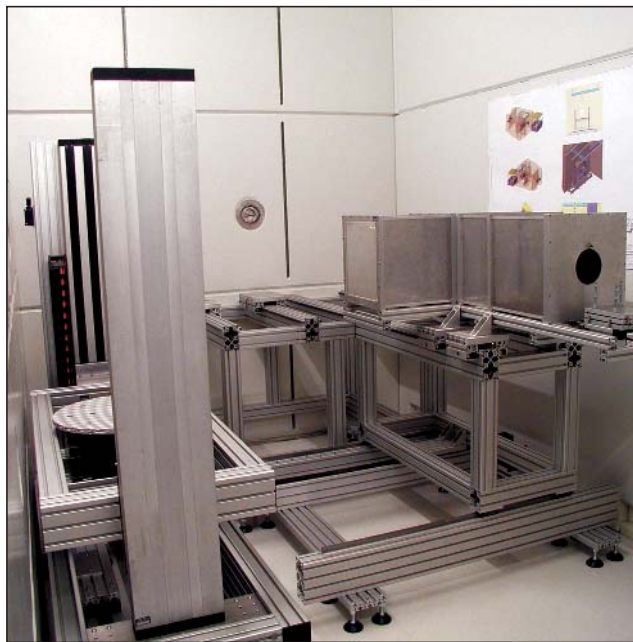
Bild 7: Blick in den Messraum von NECTAR. Links ist der Manipulator für das Messobjekt zu erkennen (der Manipulator von ANTARES ist nahezu baugleich), im Hintergrund die Vorrichtung für die Positionierung des zweidimensional ortsauflösenden Detektorsystems auf der Basis einer stickstoffgekühlten CCD-Kamera
