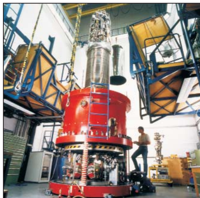
Bild 3: Van-de-Graaff-Vorbeschleuniger am ISL
