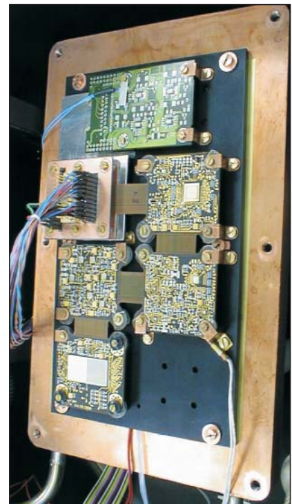
Bild 26: Moses Detektorelektronik des DLR Instituts für Weltraumsensorik und Planetenerkundung (Berlin), die vor dem Einsatz bei der Rosetta-Mission mit Protonen bestrahlt wurde (A. Denker)
