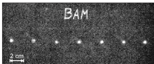
Abb. 7: Schlagschaden-Reihe in einem CFK-Laminat (Matrix-Risse und Faser-Enthftung). Der Bleistift-Schriftzug „BAM“ demonstriert die große spezifische Oberfläche von Graphit
