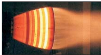
Vulcain 2 Subscale Keramikdüse beim Heißtest
