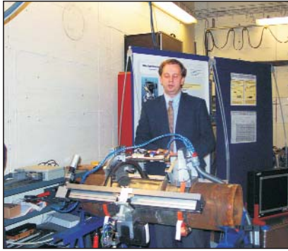
Station 4, Mechanisierte Durchstrahlungsprüfung: Bernhard Redmer bei der Vorführung der mobilen Variante einer 3D-Radioskopie-Anlage
