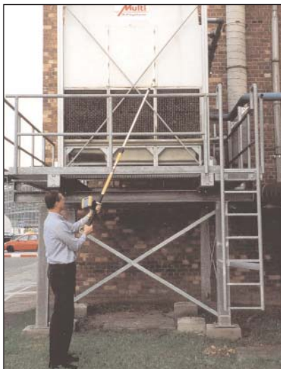
Der praktische „Video-„Spion“ für Wartungs- und Inspektionsaufgaben
