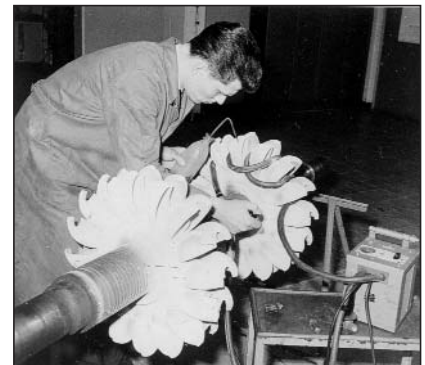
1964, Cavalar bei einer Magnetpulver-Rissprüfung an einem Turbinenläufer. Von Dr. Hecht so kommentiert: „Man sieht, der weiß was er tut und gibt mit Sicherheit einen eindeutigen Befund ab“
