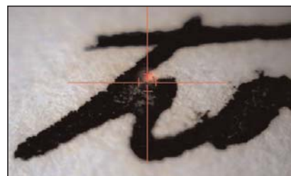
Abbildung 5: Positionierung des Messflecks mit Hilfe einer Leuchtdiode
