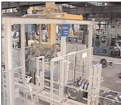
Bild 2: US Radprüfanlage BVV
