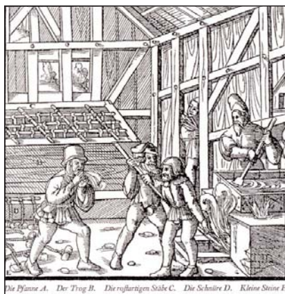
Abbildung 3: Herstellung von Vitriol, die eingekochte verdickte Lösung kristallisiert an hängenden Ruten aus (Agricola 1556)
