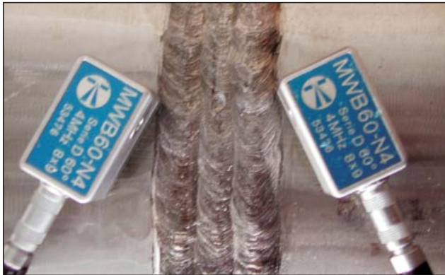
Bild 10: Querfehlerprüfung mit der „Bügeleisen-Technik“
