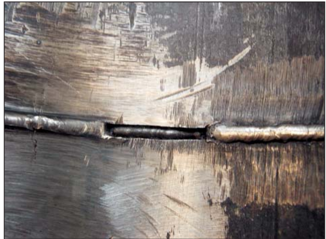
Bild 11: Nicht durchgeschweißte Wurzel
