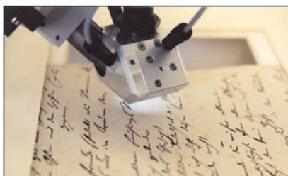
Abbildung 4: ArtTAX-Messkopf über einem Manuskript
