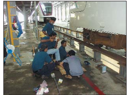
Die erste selbständige Ultraschallprüfung einer Radsatzwelle im eingebauten Zustand, kritisch beobachtet vom Supervisor
