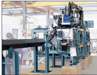
Anlage zur automatischen Oberflächenprüfung beim Probebetrieb
