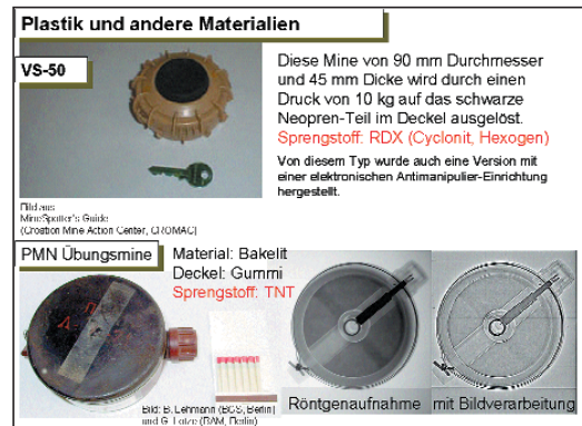
Abb. 4: Antipersonenminen: Sprengminen aus unterschiedlichen Materialien. Der Metallgehalt ist wesentlich geringer. Derartige Minen zielen mehr auf Verletzungen als auf letale Wirkung ab. Sprengstofffüllungen sind unterschiedlich (RDX = Hexogen, TNT). Der PMN-Typ ist durch den äußeren Metallring mit Metalldetektoren auffindbar. Dieser Ring kann aber entfernt werden
