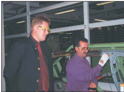
Handprüfung der Schweißpunkte mit Ultraschall
