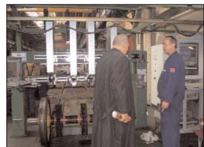
Vor dem automatischen Prüfstand: Prof. Wüstenberg im Gespräch mit dem Prüfer Detlef Devantier, der in einer Schicht rund 80 Radwellen prüft
