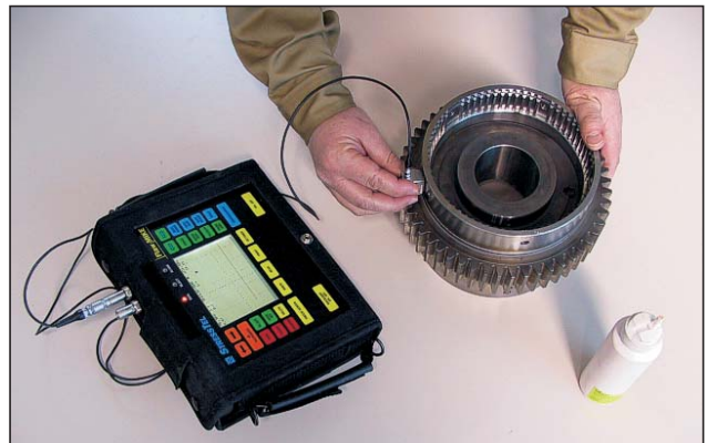
Bild 1: Manuelle Prüfung der Zahnräder nach dem Schweißprozess
