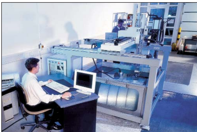
Bild 2: Bei der Ultraschallprüfung im Tauchtechnikverfahren wird der Prüfkopf mit einem 6-Achsen-Manipulator im Tauchbecken bewegt
