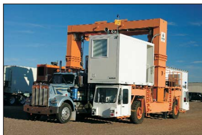
Bild 1: System zur Abbildung von Röntgenquellen, verwendet für die Prüfung von Raketen, Kernwaffen, Fahrzeugkomponenten, elektronischen Geräten und fortgeschrittenen Werkstoffen
