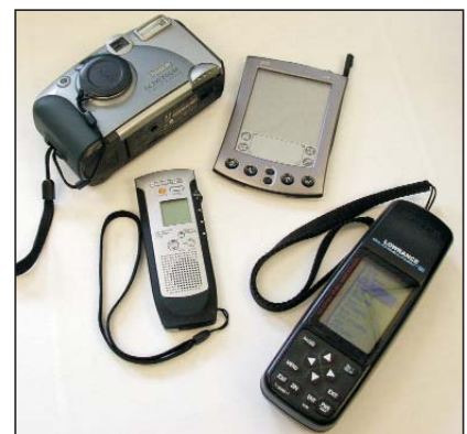
Bild 3: Zur Ausrüstung des Teams der Georgia Tech bei der Datensammlung gehören ein persönlicher Datenassistent, ein kleines GPS-Gerät zur Standortbestimmung, eine Digitalkamera und ein Diktiergerät (das Foto wurde freundlicherweise bereitgestellt von Norris Scott/Georgia Tech ©2002)
