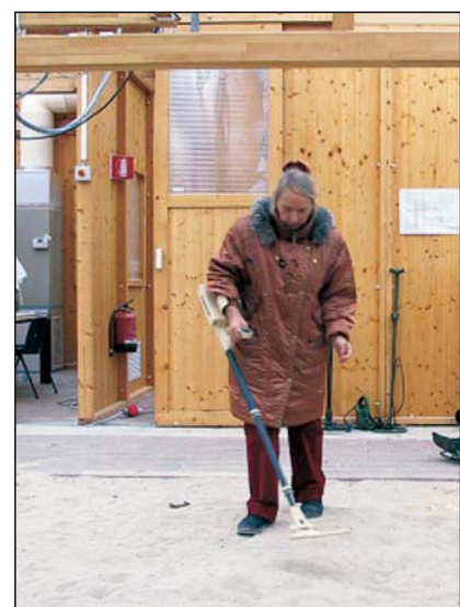
Bild 4: Die Autorin dieses Beitrages beim Funktionstest von verschiedenen Metalldetektoren auf Sandboden
