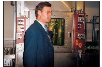
Herr Harsch demonstrierte die Farbeindringprüfung an Hinterachsträgern
