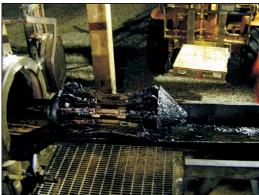
Alarm-Molch nach Durchgang durch eine Rohölleitung in der Nordsee
