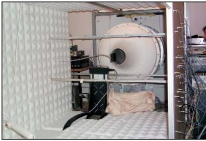
Aeroakustischer Windkanal mit extrem leisem Freistrahle (maximale Strömungsgeschwindigkeit ca. 40 m/s)
