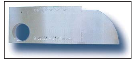
Kalibrierkörper K1 nach DIN EN 12223
