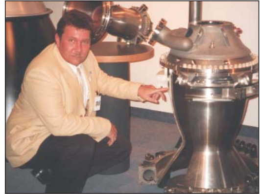
Markus Blumauer, verantwortlicher Stufe 3-Mann in der Werkstoff-/Bauteilprüfung, erläutert die ZfP an der Brennkammer (Kupferkern, außen galvanisch Nickel). Mit Ultraschall wird auf Schmiedefehler geprüft, bei der Integration die Schweißnähte mit Ultraschall, teilweise Röntgenprüfung
