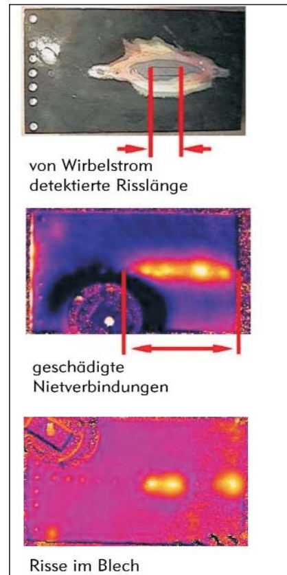
Abb. 5: Vergleich einer Wirbelstrommessung (oben) mit einer Ultraschall-Lockin Thermografie Messung (mitte). Das Phasenbild bei 0,5 Hz (unten) zeigt eine Wiederholungsmessung nach entfernen der Nietreihen. Risse im Blech leuchten dann selektiv auf
