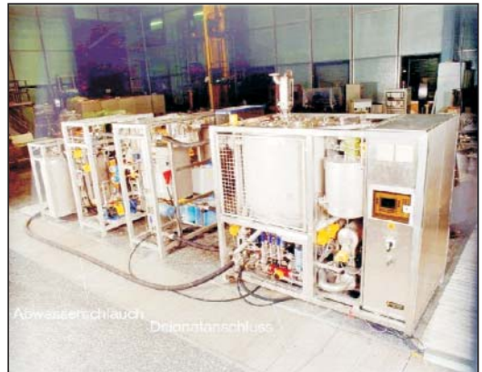
Abbildung 4: Cord-Verfahren für die Behandlung von Kleinteilen
