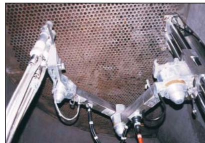
Abbildung 1: DE-Prüf- und Reparaturmanipulator mit Doppelmundstück
