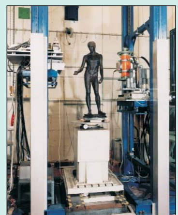
Die antike Bronzestatue Idolino aus Florenz auf dem Universaltomographiestand der BAM
